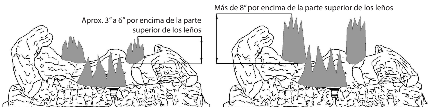
Fig. 26: Patrón de la llama del quemador correcto incorrecto
