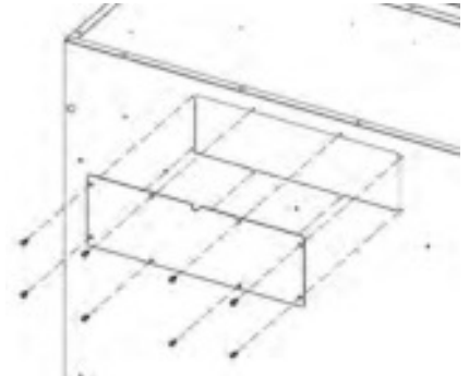
Fig. 6—Acople el conducto del soplador
