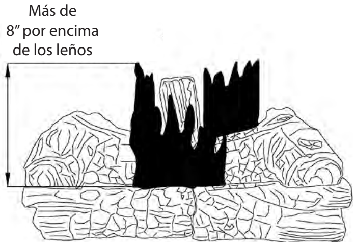
Fig. 25: Patrón de llama incorrecto del quemador
