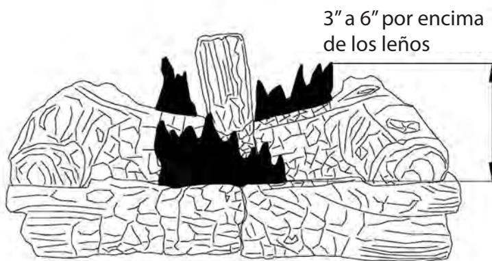
**Fig. 25: Patrón de llama incorrecto del quemador**
